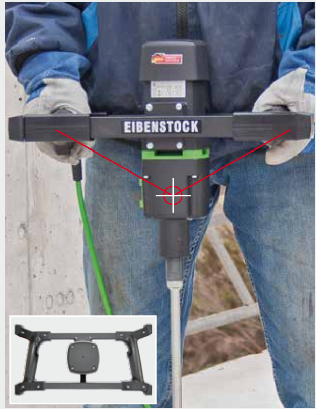
Breite, ergonomische Rahmengriffe in Trapezform und ausgewogener Schwerpunkt - leichtes, ausbalanciertes Führen der Maschine, größere Hebelwirkung
