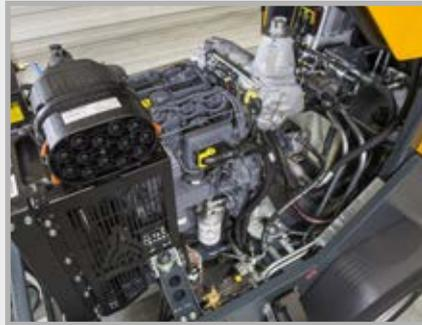
O motor robusto e compacto de três cilindros da Deutz satisfaz todos os requisitos da norma de emissões „Stage V“, aplicável na UE e na Suíça.
