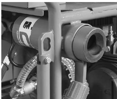
Figura 25: Ajuda de inserção com revestimento do sem-fim
