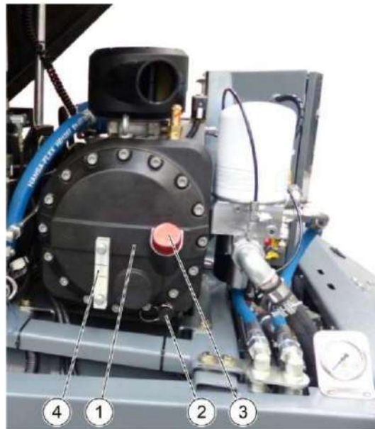
Figura 84: Drenagem do óleo do compressor
