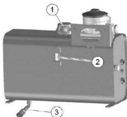
Figura 75: Tanque de óleo hidráulico
