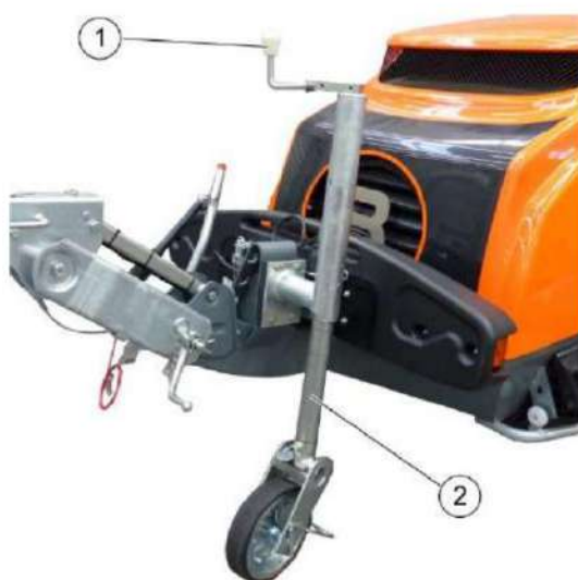
Figura 39: Nivelando a máquina
