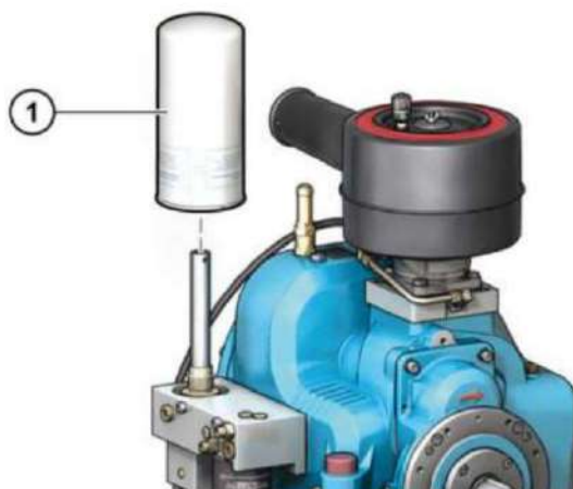
Figura 86: Troca do elemento removedor de óleo de ar
