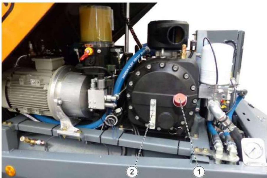
Figura 80: Verificação do nível de óleo do compressor - EC 350-32A
