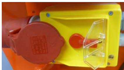
Figura 39: Defina o inversor de fase para a posição '0'
