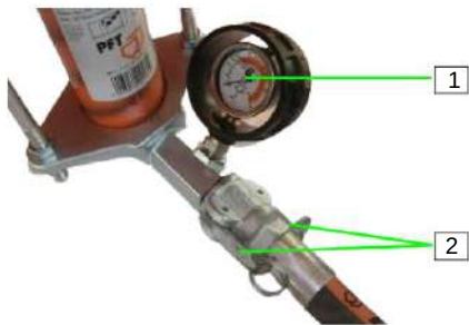
Figura 102: Desconexão da mangueira de argamassa
