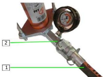
Figura 68: Conectando a mangueira de argamassa
