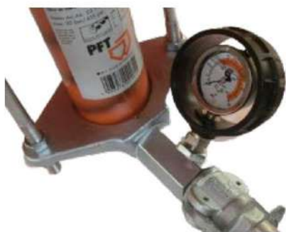
Figura 19: Manômetro de pressão da argamassa
