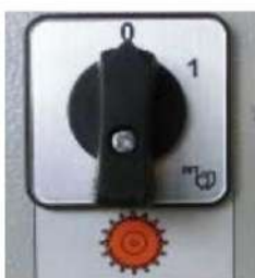
Figura 23: Seletor para válvula rotativa 230V
