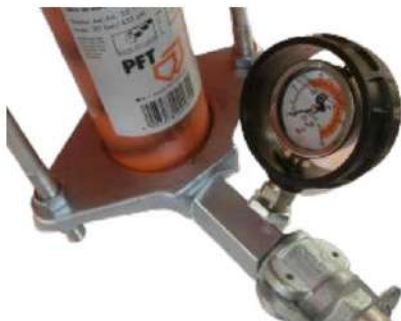
Figura 37: Manômetro de pressão da argamassa
