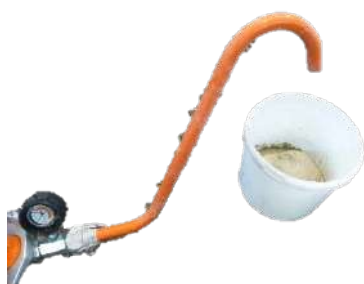
Figura 56: Tubo de teste de consistência
