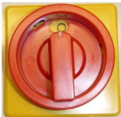
Figura 70: Interruptor principal na posição «0»
