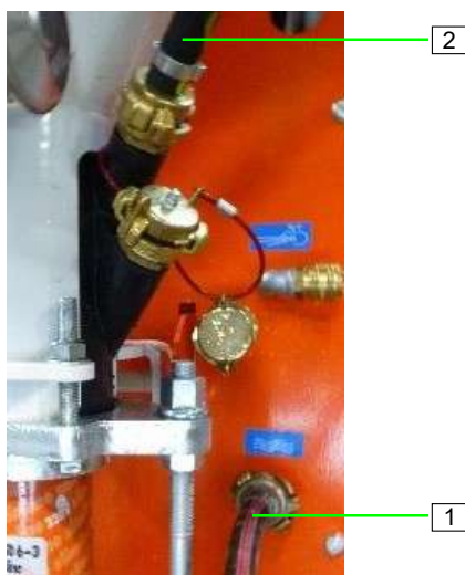
Figura 73: Separe o fornecimento de água
