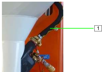
Figura 81: Conectando a mangueira de água
