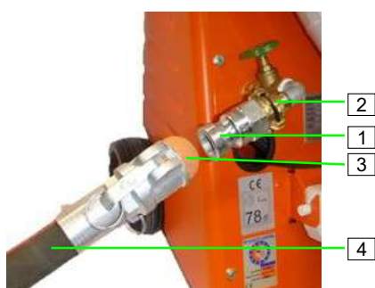
Figura 79: Limpando a mangueira de argamassa
