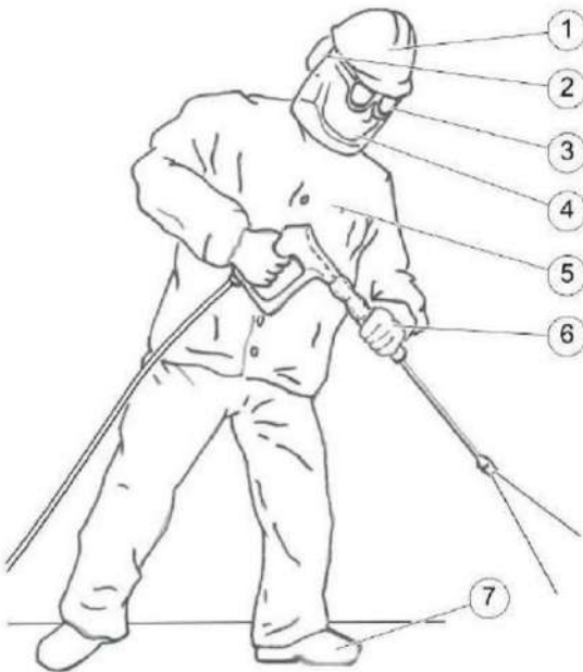
Figura 1: Equipamento de proteção para trabalho com jatos de água de alta pressão
